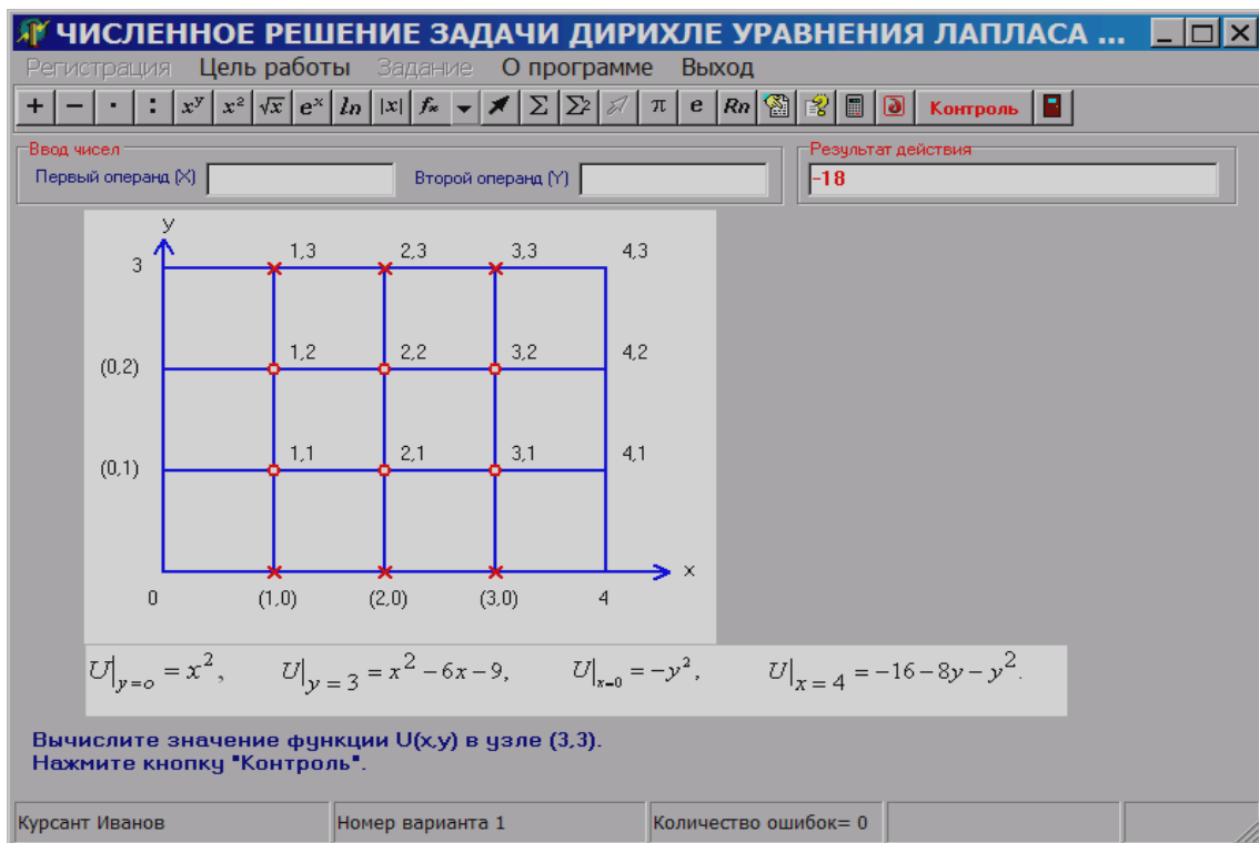
Рис. 6. Численное решение задачи Дирихле для уравнения Лапласа методом сеток
