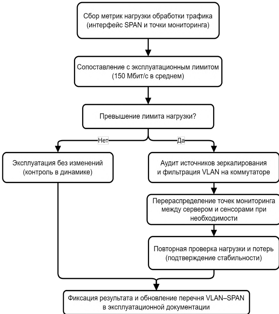
Рис. 2. Контроль нагрузки VLAN-SPAN и фильтрация VLAN
