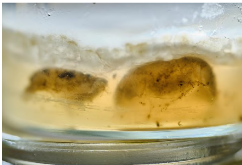
Рис. 1. Hormoconis resinae в авиационном топливе
