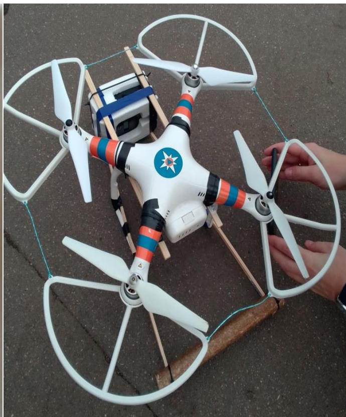
Рис. 5. Внешний вид воздушного комплекса: БПЛА, снабженный разработанным газоанализатором, для определения состава воздуха в труднодоступных местах на предприятиях и поиска пострадавших под завалами
