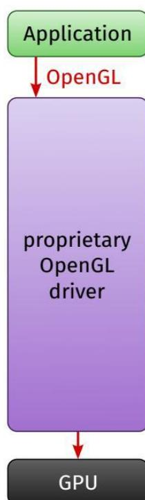
**Рис. 1. Графическое представление обращения приложения к GPU с помощью OpenGL**
