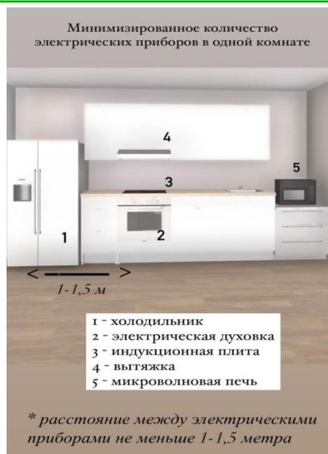
**Рис. 5. Правильное распределение электрических приборов в одной комнате**
