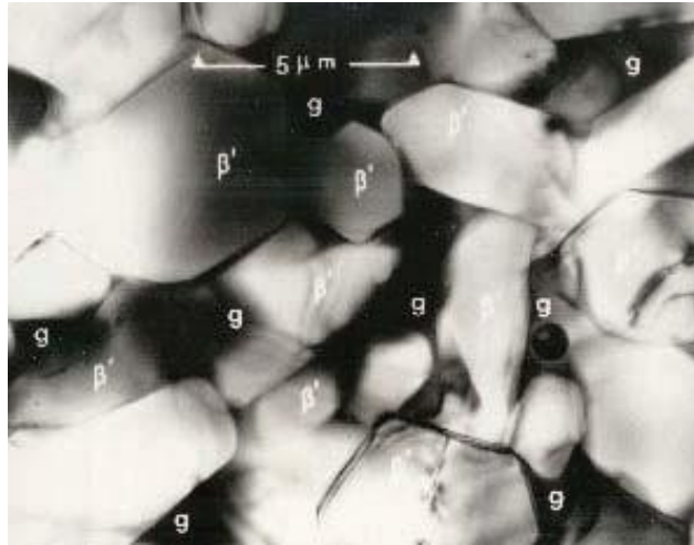
Рис. 2. Зерна сиалона – \beta в окружении стекло фазы – g
