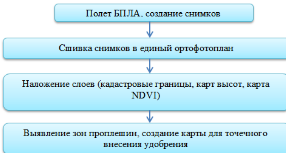
Рис. 2. Этапы работ с использованием БПЛА
