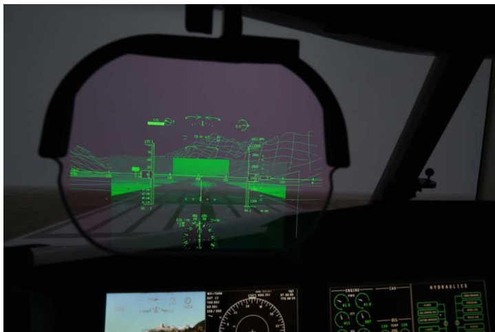
Рис. 6. Комбинированное изображение SVS и EVS на базе миллиметрового радара
