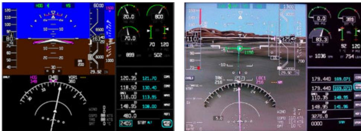
Рис. 1. 3D-изображение системы SVS в сравнении с обычной индикацией
