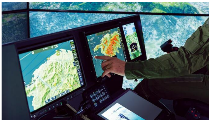
Рис. 7. Прототип системы индикации на базе индикаторов высокого разрешения с диагональю 15" с отображением информации системы SVS
