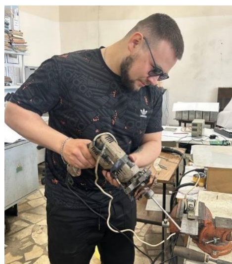
Рис. 1. Установка для электроискровой обработки SZ-8100 и процесс обработки ножа
