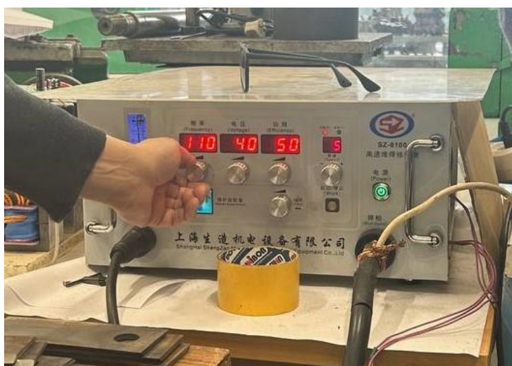
Рис. 1. Установка для электроискровой обработки SZ-8100 и процесс обработки ножа
