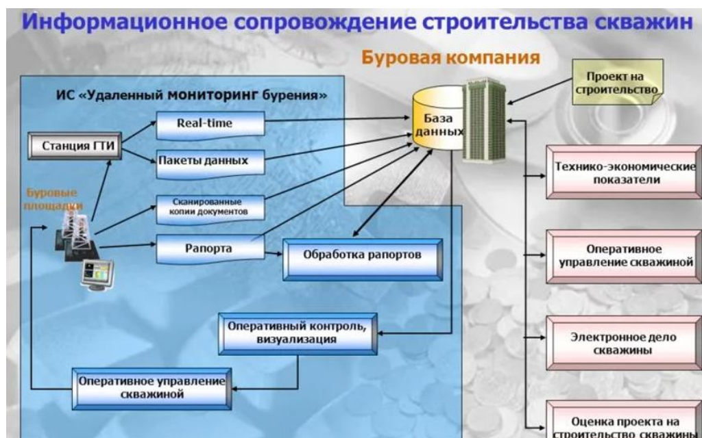
Рис. 1. Схема информационных потоков в информационной системе сопровождения строительства скважин
