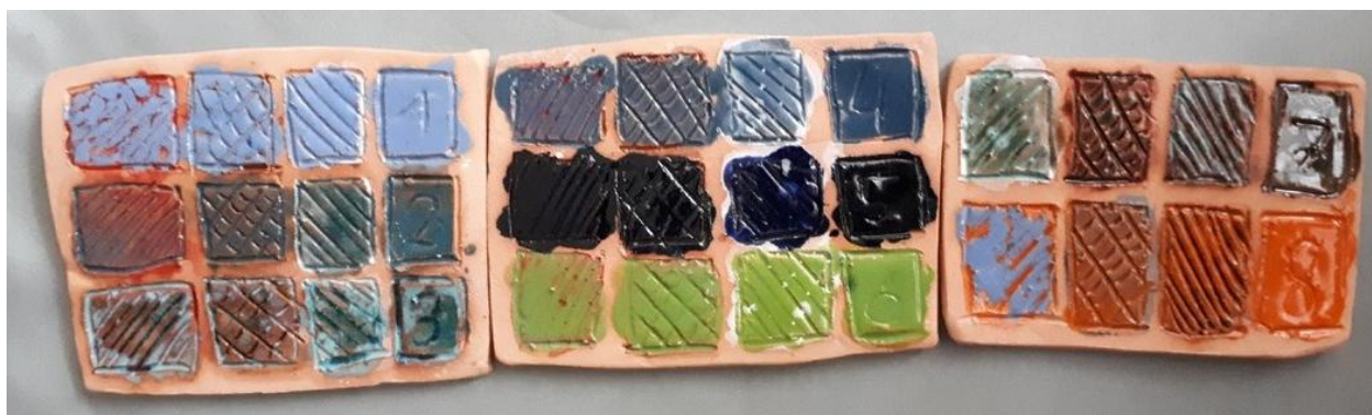
Рис. 3. Пробные обжиги глазури на керамике
