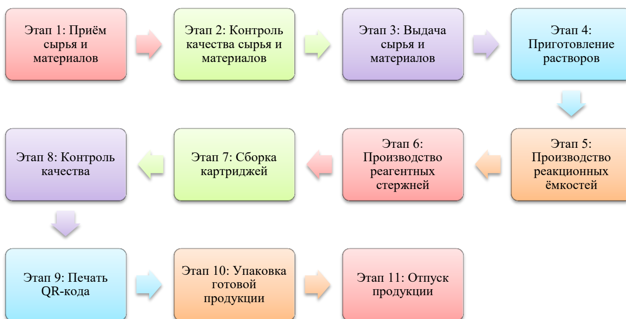
Рис. 3. Этапы производства тест-системы Shyrai A1c
