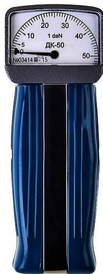
Рис. 1. Динамометр кистевой ДК-50.
