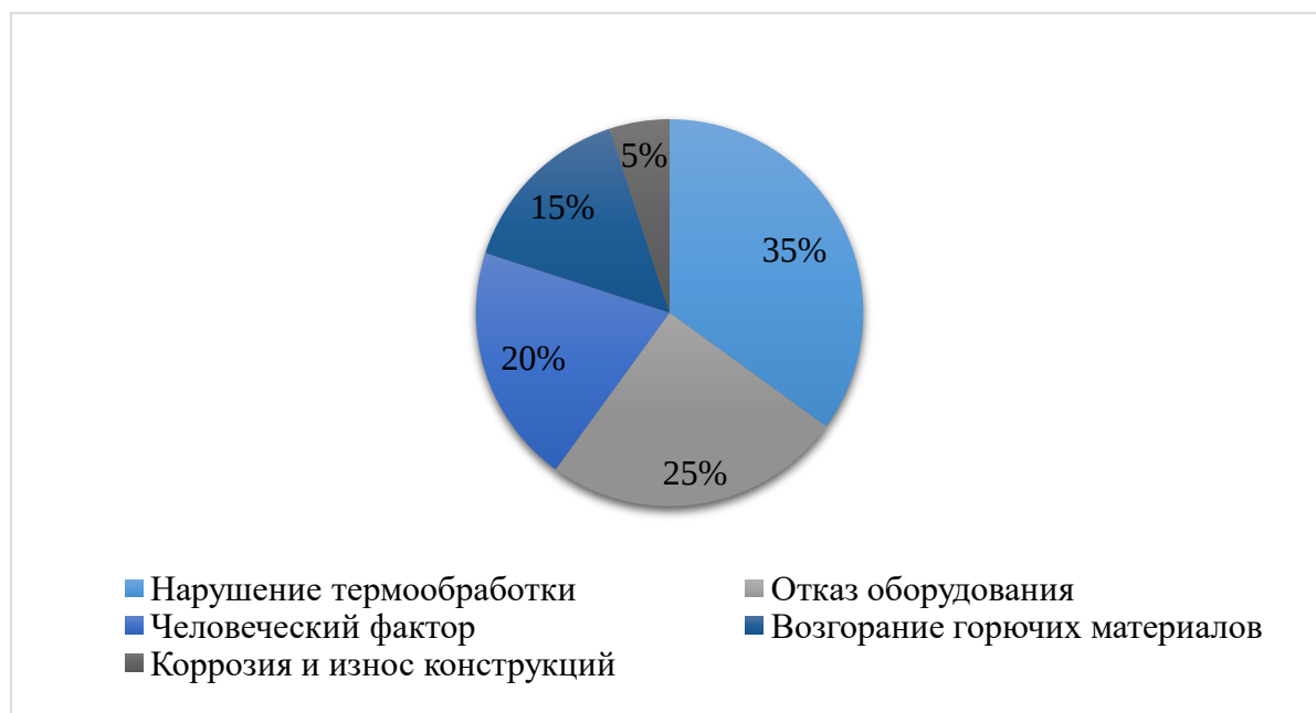
Рис. 1. Основные причины аварийных ситуаций участков термообработки
