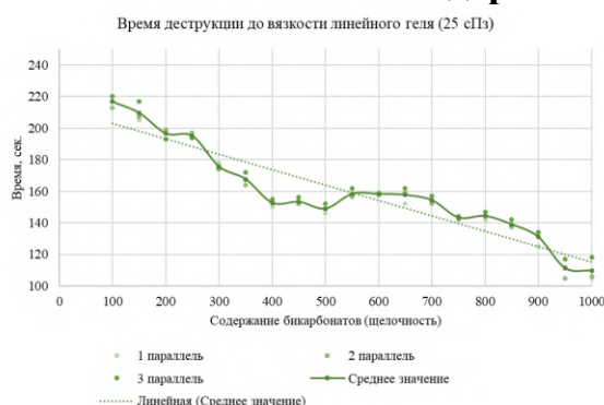
Рис. 9. Время деструкции сшитой системы до вязкости линейного геля в зависимости от содержания бикарбонатов
