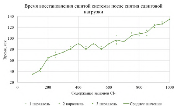
Рис. 5. Время восстановления сшитой системы в зависимости от содержания хлоридов
