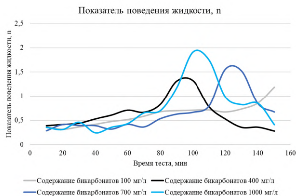
Рис. 11. Показатель поведения n жидкости разрыва с различным содержанием бикарбонатов
