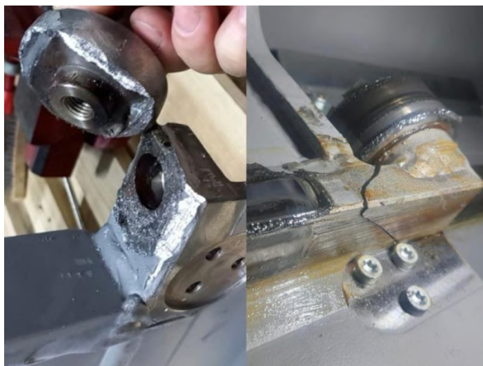
Рис. 1. Разрушение профиля мачты в местах крепления осей, в результате неравномерно распределенного момента сил
