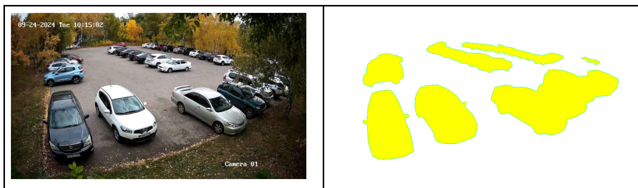
Рис. 2. Пример результата сегментации парковочного пространства
