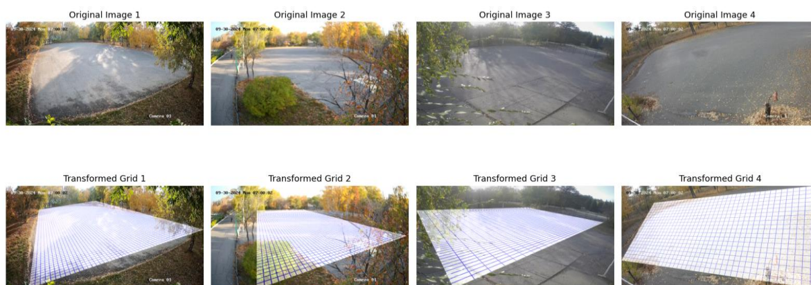
Рис. 4. Изображение с камер и их матричная разметка
