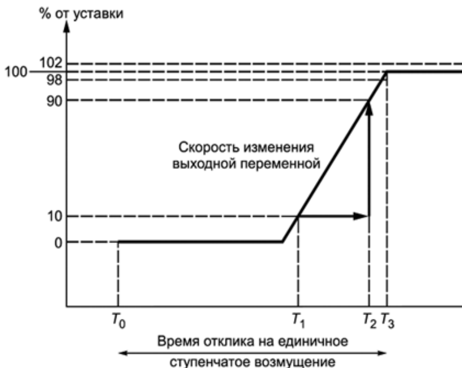
Рис. 7. Время отклика на единичное ступенчатое возмущение и скорость изменения выходной переменной СНЭЭ [3, с. 15]
