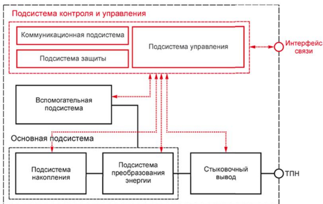
Рис. 2. Типовая архитектура СНЭЭ [3, с. 10]
